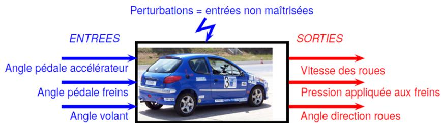
FIGURE 1.6 – Avant la modélisation, on définit les entrées et les sorties du système étudié.
