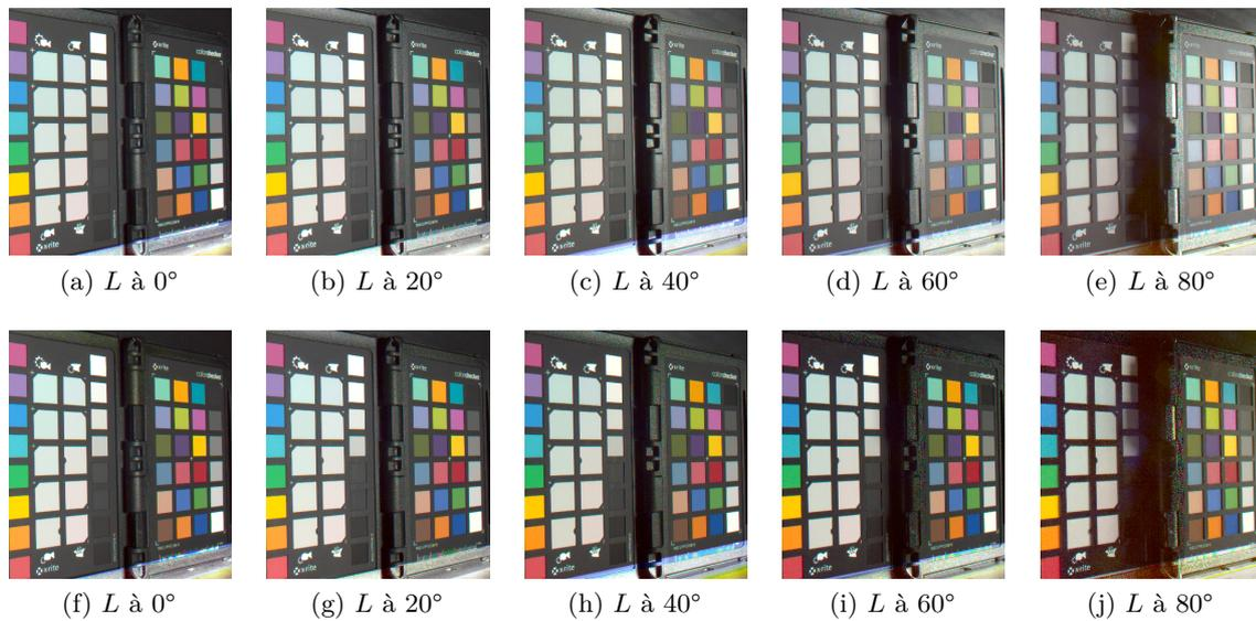
FIGURE 3.30 – Haut : transformation sRGB des images spectrales. Bas : Transformation sRGB des images spectrales après suppression de la composante polarisée spéculaire. Le système d'imagerie est fixe et positionné à  $45^\circ$  par rapport à la normale de la mire. L'angle d'incidence de l'éclairage est augmenté de  $[0, 80]^\circ$  par pas de  $20^\circ$ . (a) et (f) sont prises avec l'éclairage à la normale de la mire.
