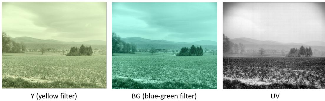
FIGURE 3.31 – Principe de l'acquisition. Les images issues des trois caméras filtrées sont alignées et recombinaées pour obtenir des données spectropolarimétriques.
