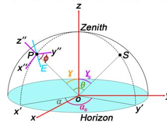
Figure 6 : Polarisation du ciel : direction du champ électrique  $E$  dans le repère local avec  $\gamma$  : angle zénithal,  $\alpha$  : angle azimutal,  $\phi$  : angle de polarisation et  $\theta$  : angle de diffusion.  $S$  signifie Soleil.
