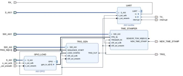
Figure 5 : Architecture du bloc des caméras et de l'IMU.
