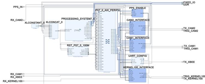
Figure 4 : Schéma-bloc global de la partie FPGA de la carte Trenz.
