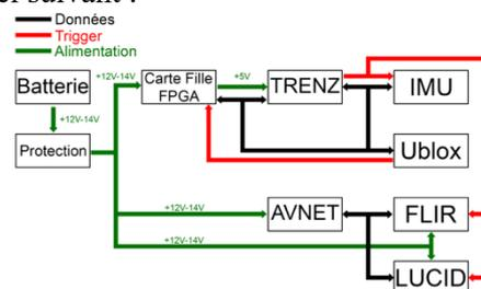
**Figure 3 : Schéma fonctionnel de l'architecture matérielle.**
