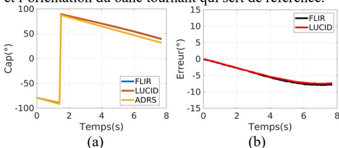
Figure 9 : (a) Comparaison entre le cap calculé à partir des données des caméras Flir et Lucid et celui donné par le feedback
